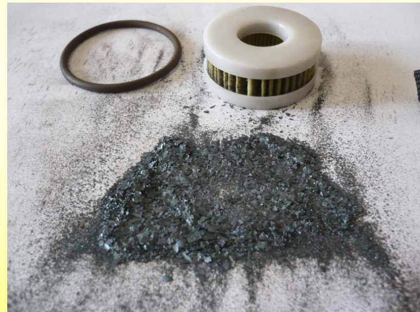
Ablagerungen aus einem verstopfte Filter
